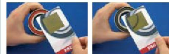
图4：使用FAG检测卡，来识别带有ABS脉冲信号发生环的轮毂轴承(右图有脉冲信号)
