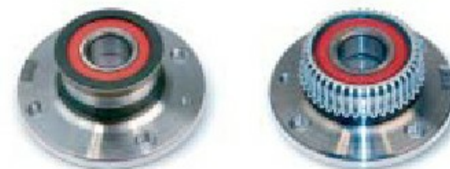
图1：带ABS脉冲信号发生环的轮毂(左)和带传统的ABS传感器环的轮毂(右)
